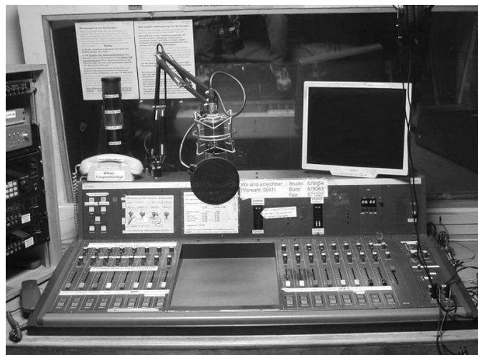
Technik- u. Sprechplatz in einem: Selbstfahrerpult (Phot.: Verf.)
